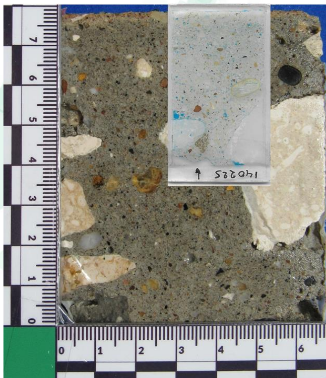
Figura 27. Fotografía del bloque semipulido de la muestra N2. Se detalla la textura y distribución de los diferentes componentes de la muestra. Además, se señala la localización de la sección delgada.
