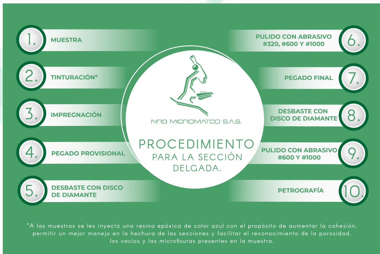
Figura 13. Procedimiento para la elaboración de una sección delgada (SD)
