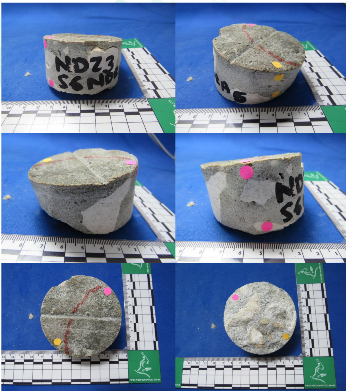
Figura 6. Fotografías de la muestra N6, mostrando vistas laterales, la parte superior y parte inferior del núcleo. Los puntos naranja y rosado muestran la orientación de los cortes.
