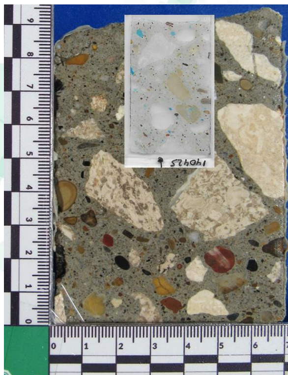
Figura 29. Fotografía del bloque semipulido de la muestra N4. Se detalla la textura y distribución de los diferentes componentes de la muestra. Además, se señala la localización de la sección delgada.
