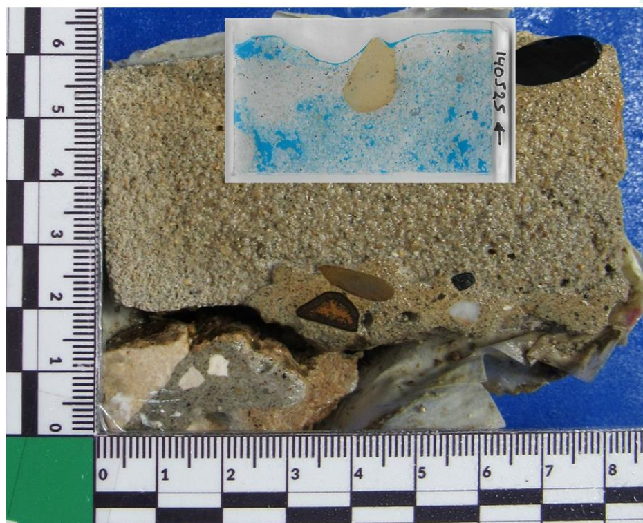
Figura 30. Fotografía del bloque semipulido de la muestra N5. Se detalla la textura y distribución de los diferentes componentes de la muestra. Además, se señala la localización de la sección delgada.
